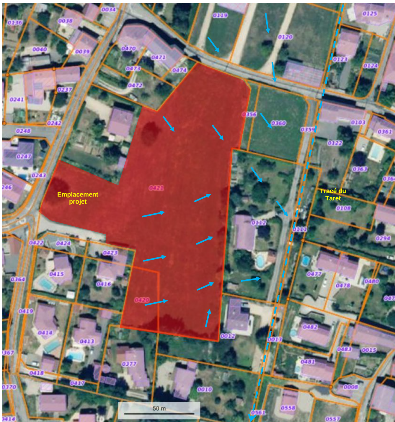
Ecoulement des eaux de ruissellement sur la parcelle projet et les terrains en aval
